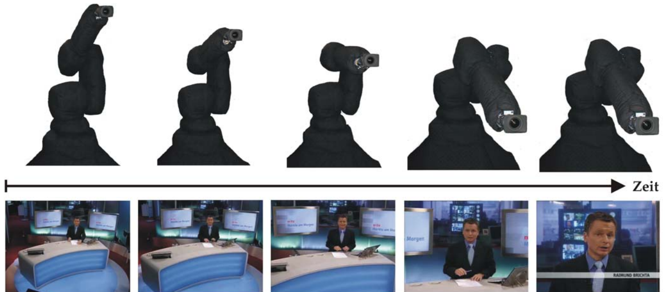
Abbildung 6: Ablauffolge einer typischen Szenenfolge („Eröffnungsfahrt“ einer Nachrichtensendung). Obere Reihe: Stellung des Roboterarms. Untere Reihe: Korrespondierendes Kamerabild des Sprechers. Die letzten beiden Bilder resultieren aus einem stehenden Roboter bei gleichzeitig weiterfahrendem Kamera-Zoom.
