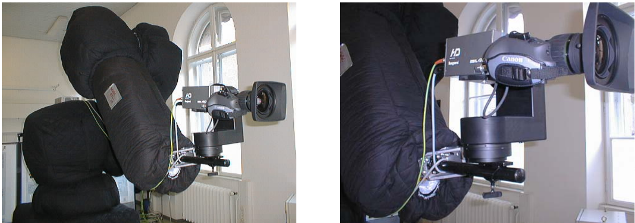
Abbildung 4: Das System „RoboKam“ in spezieller Konfiguration mit montierter Schwenk-Neigeeinheit (zwei Zusatzachsen). (a) Gesamtansicht, (b) Detailansicht der Schwenk-Neigeeinheit.
