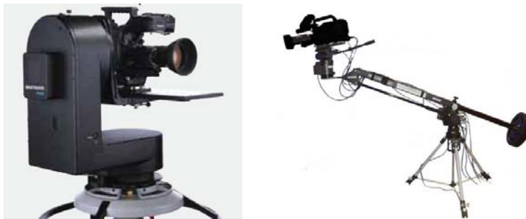
Abbildung 2: Weitere Vorrichtungen zur Bewegung von Studiokameras: (a) Elektrisches Fahrstativ und Schwenk-/Neigeeinheit zur Fernsteuerung des Kameraortes (Fa. Radamec), (b) Kamerakran für schnelle Schwenks (Fa. Shotoku).
