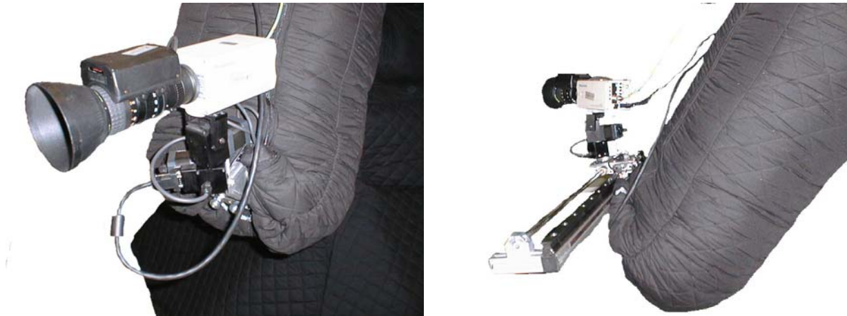
Abbildung 5: Weitere Konfigurationen des Systems „RoboKam“. (a) Kleinere Schenk-Neigeeinheit für Kameras mit geringerem Gewicht, (b) zusätzlich montierte Linearschiene (mit Linearmotor) und darauf angebrachter kleiner Schwenk-/Neigeeinheit.
