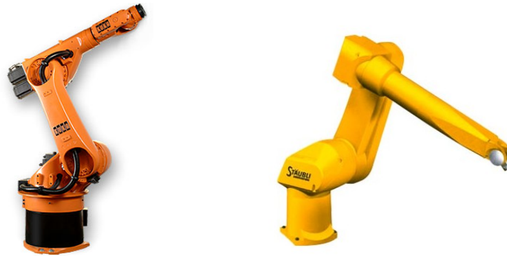
Abbildung 3: Typische Industrieroboter-Arme, wie sich sich prinzipiell zur Verwendung im Studio eignen. (a) Roboter KR 30 der Firma Kuka, (b) Roboter RX 130 XL der Firma Stäubli.
