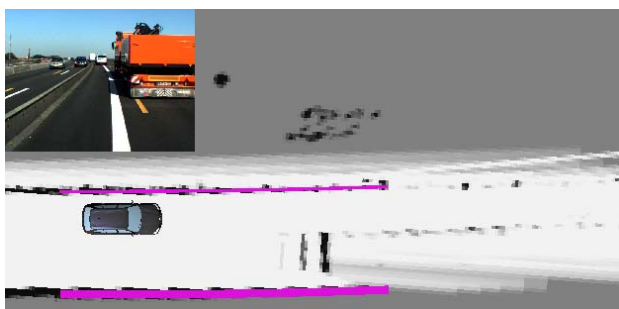
Abbildung 13. Beispiel für die Erkennung von zwei Randbebauungen (rot) aus dem Occupancy Grid mO in einem Baustellenszenario.
